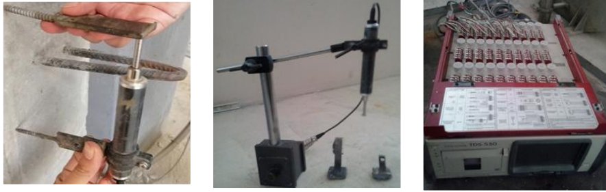
الشكل(10) جهاز قياس الانتقالات والتشوهات، والحساس .
