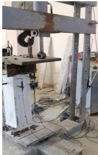
الشكل (9) جهاز الكسر و تموضع العمود المختبر
