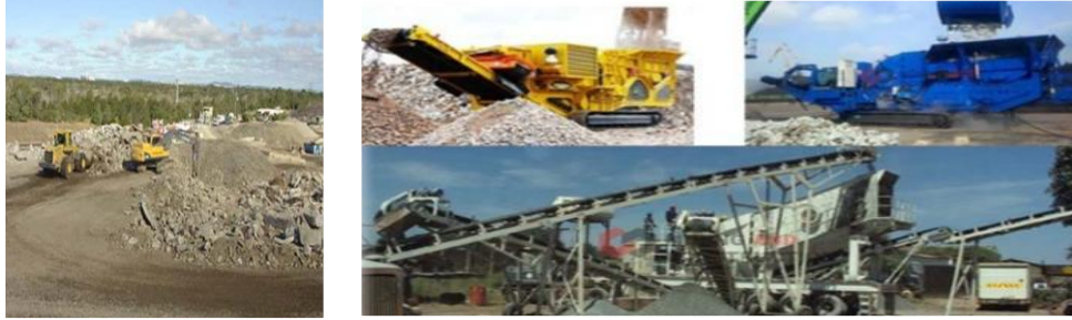
الشكل (2) محطات تكسير متنقلة تستخدم في الموقع
