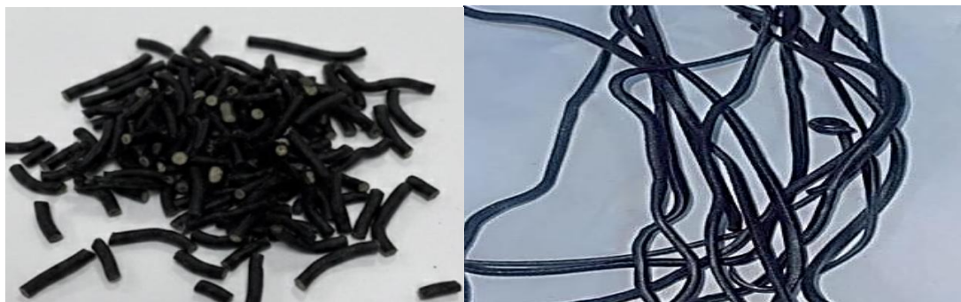
شكل 4: شكل الخلطات بعد البثق (خيوط لمتراكبات او المواد المركبة).
